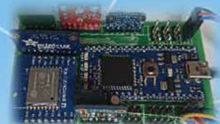
屋内農場用IoT装置の開発と運用。農作物環境の確認やエアコンでの環境制御が可能
