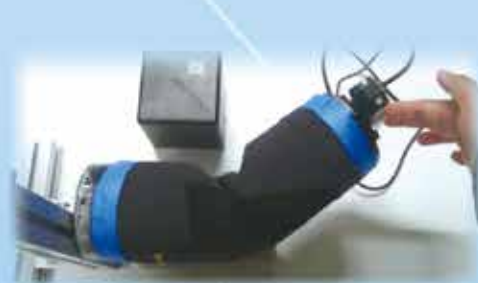
ヒューマノイドロボット開発技術を用いた健康衣料評価装置（例：膝サポーター）
