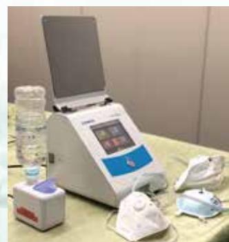
労研式マスクフィッティングゲスターMT-05U型本機を使ってマスクフィットテストを行う
