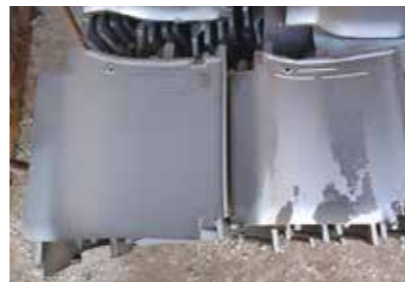
左: ガス窯で製造された瓦 右: 達磨窯瓦
